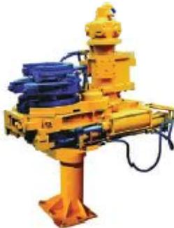
Используется в составе буровых установок для свинчивания и развинчивания бурильных и обсадных труб в процессе спуско-подъемных операций при бурении нефтяных и газовых скважин.
