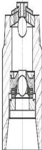
Предназначены для непрерывного самонаполнения спускаемой обсадной колонны промывочной жидкостью или цементным раствором, предотвращения обратного движения жидкости (раствора) из затрубного пространства в колонну в процессе ее цементирования и для упора разделительной цементировочной пробки.
