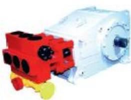
Насосы серии НТП 300-800хР (300-800 — наибольшая мощность насоса, Р — наибольшее давление насоса) — горизонтальные трехплунжерные одностороннего действия. Предназначены для подачи жидкостей неагрессивных сред при гидролепестиструйной перфорации, промывке песчаных пробок, освоении скважин, законченных бурением, и других промывочно-продавочных работ, проводимых в нефтяных и газовых скважинах. На базе одного насоса НТП можно получить насосы разной производительности и разного назначения.
