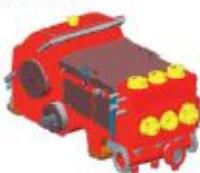
Трехплунжерный насос НТП-175 со встроенным редуктором и сменными плунжерами. Обеспечена возможность быстрой замены плунжеров разного диаметра. НТП-175 используется вместо насосов НЦ-320 на установках УНБ-125хР в качестве силового насоса.
