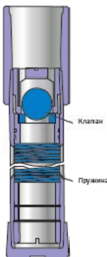
Фильтрующим элементом служит пружина.
