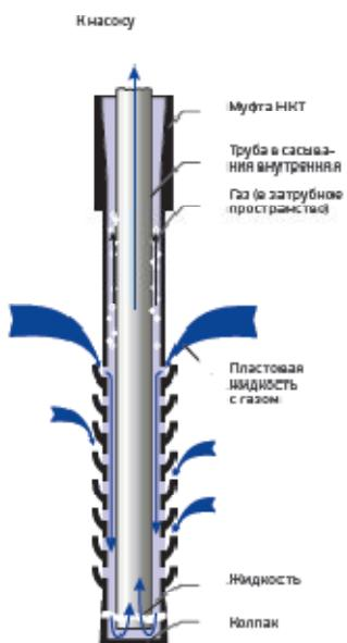
Предназначен для сепарации газа из нефти при ее откачке штанговыми насосами. Обычно используется до трех соединенных между собой газовых якорей, навинченных на колонну НКТ под насосом и представляющих собой внешнюю трубу всасывания. К нижнему якорю присоединяется заглушенная колпаком труба НКТ, а в приемное отверстие насоса ввинчивается внутренняя труба всасывания, выходящая в нижнюю (заглушенную) трубу НКТ. Внутренняя труба всасывания в комплект поставки якоря не входит.
