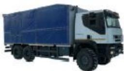
Установка насосная УНБ-600х50 предназначена для приготовления тампонажных и нагнетания различных жидкых сред в нефтяные и газовые скважины при цементировании, гидропескоструйной перфорации, промывке песчаных пробок, проведении промывочно-продавочных работ при освоении и капитальном ремонте нефтяных и газовых скважин.
