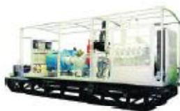
Установка предназначена для нагнетания рабочих сред при бурении, освоении и других промыслово-продовочных работах в газовых и нефтяных скважинах. Оборудование установки закрыто тентом.
