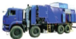
Установка насосная УНБ2-600х70 предназначена для приготовления и нагнетания тампонажных растворов в скважину, нагнетания различных жидких сред при проведении гидрорезонансной перфорации, промывки песчаных пробок, проведения промывочно-продавочных работ при освоении и капитальном ремонте нефтяных и газовых скважин.
