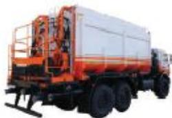
Установка смесительно-осреднительная передвижная УСП-20К предназначена для осреднения и гомогенизации раствора в емкости путем его перемешивания ленточным шнеком, а также рециркуляции центробежным насосом.
