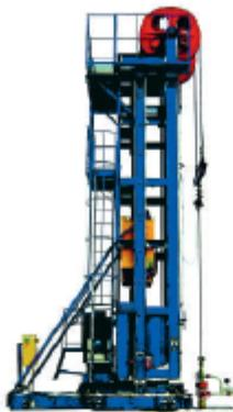
Является высокоеффективным энергосберегающим оборудованием для добычи нефти. Предназначен для эксплуатации высокодебитных (до 100 т/сут.) скважин и добычи высоковязкой продукции, а также для межскважинной перекачки воды для поддержания скважинного давления.
