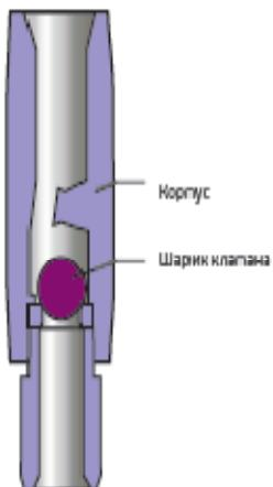
Предназначен для поинтервальной опрессовки колонны НКТ при спуске ЭЦН, а также перекрытия потока жидкости при остановке насоса.
